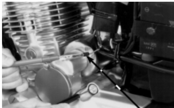
CONECTOR DO GERADOR DE PULSOS DA IGNIÇÃO
