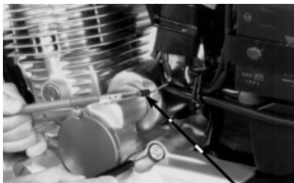
CONECTOR DA BOBINA DE EXCITAÇÃO BOBINA DE IGNIÇÃO
